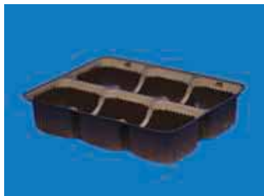
82007 6 Cell Tray O.D.: 4.875 x 3.875 x 1.000 I.D.: 1.250 x 1.250 x 1.000 Mat.: OPS, HIPS
